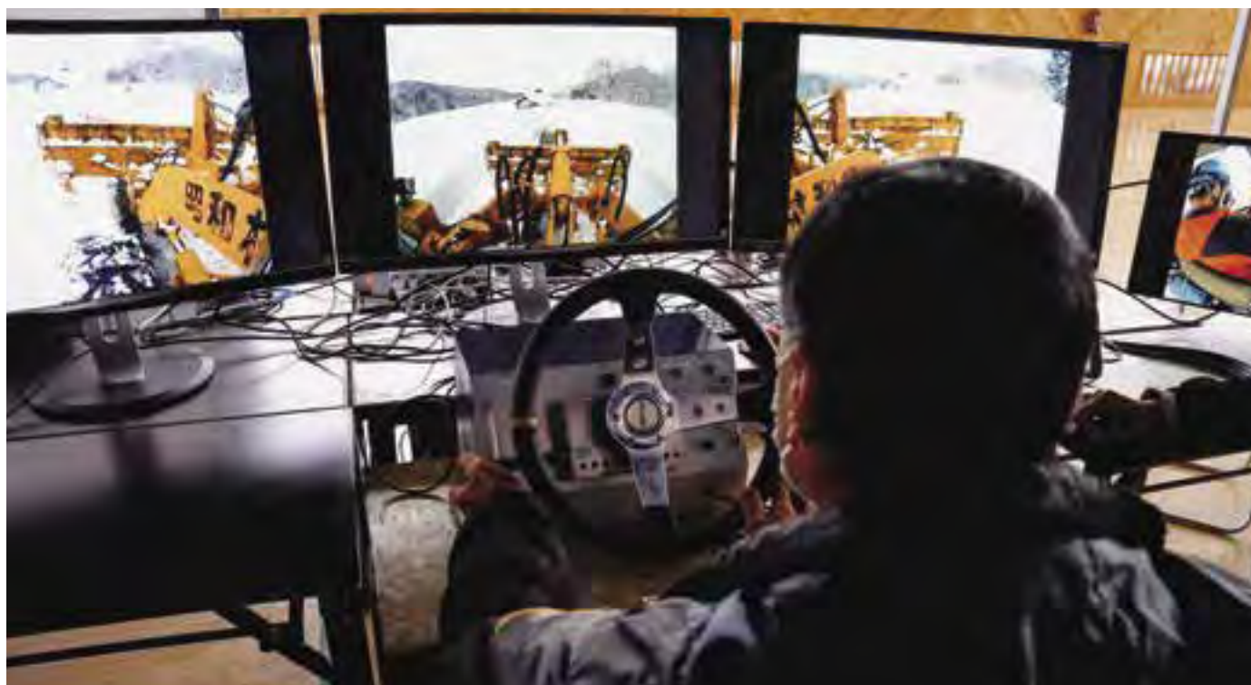
除雪車両の遠隔操作実証実験
